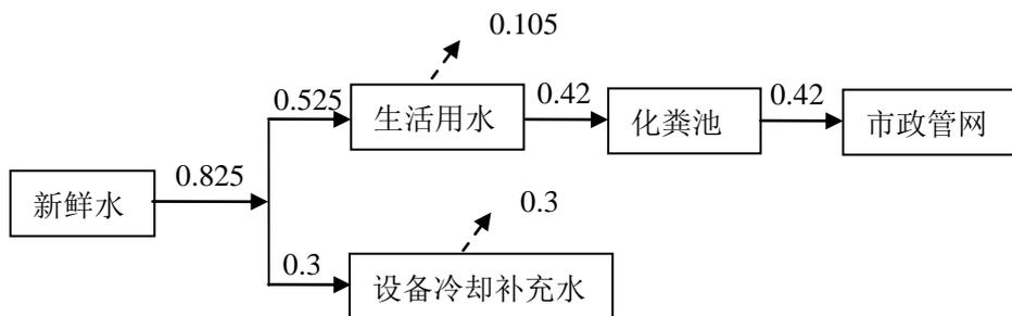
图 1 项目水平衡图 单位: t/d
