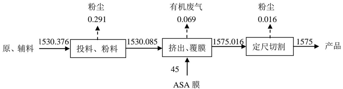
图 2 项目物料平衡图 (t/a)
