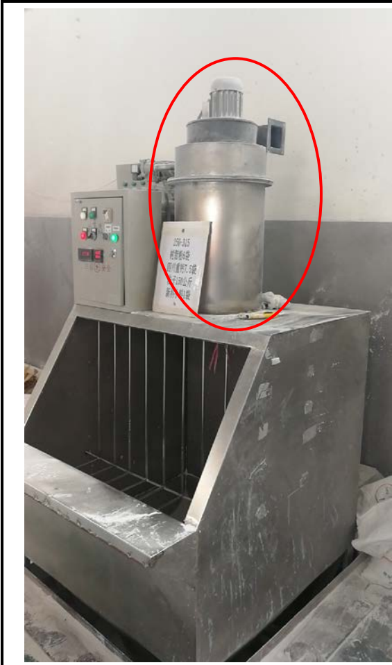
卸料除尘装置
