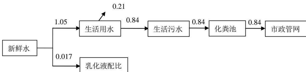
图 1 项目水平衡图 单位：t/d
