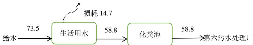
图1 项目水平衡图 (单位：m<sup>3</sup>/a)
