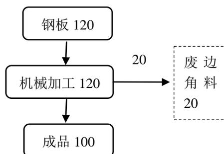
图 3 项目物料平衡图 (单位: t/a)
