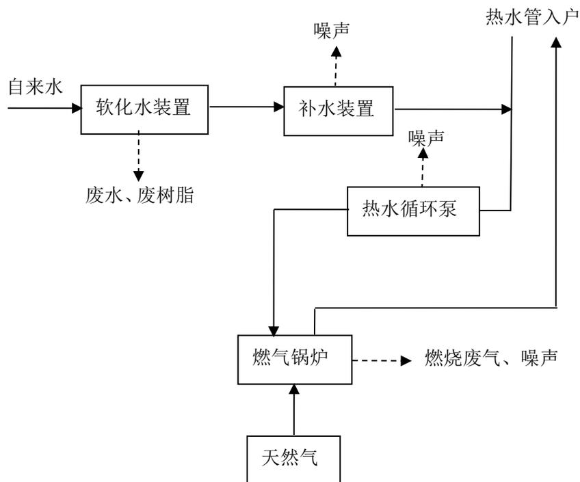
图2 生产工艺及产污环节流程图
