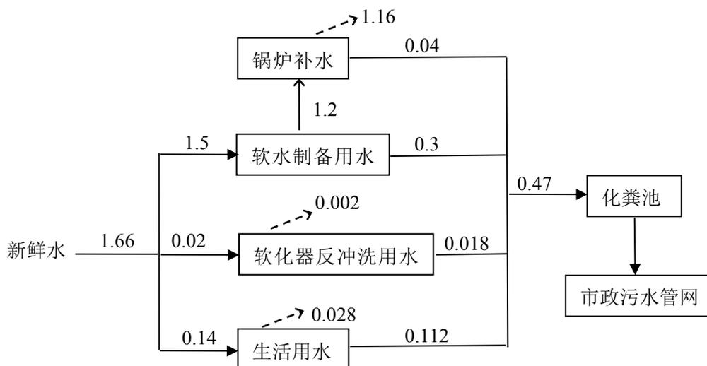
图 2 本项目用水平衡图 单位 m<sup>3</sup>/d
