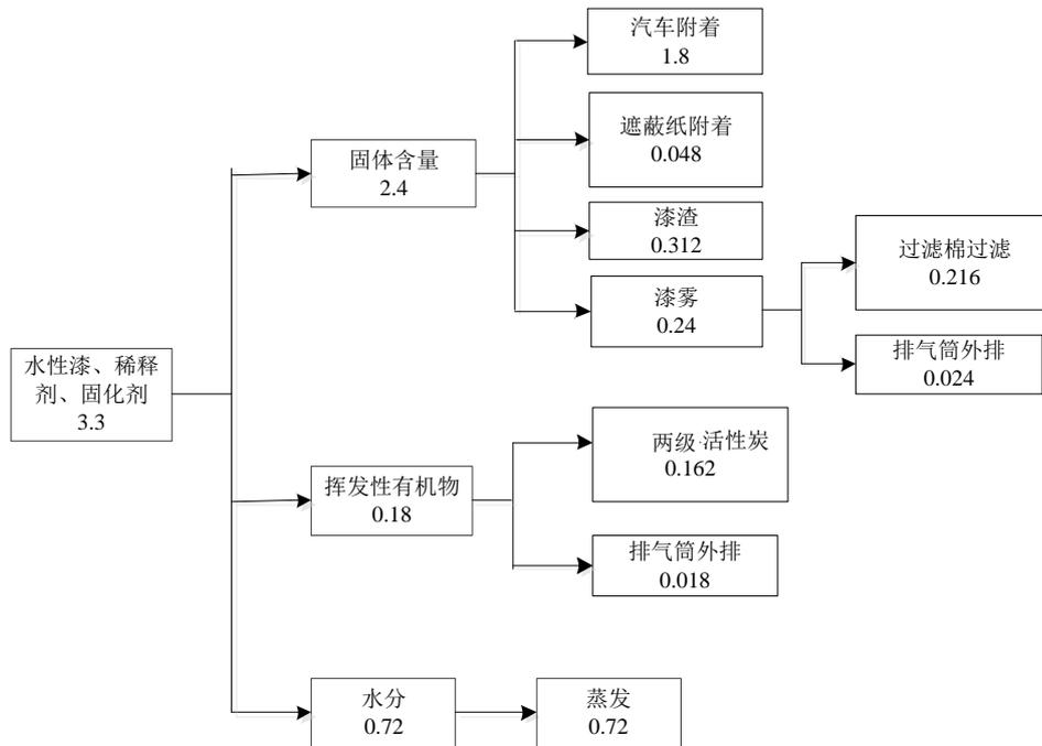
图 5.2-2 漆料平衡图 (单位: t/a)
