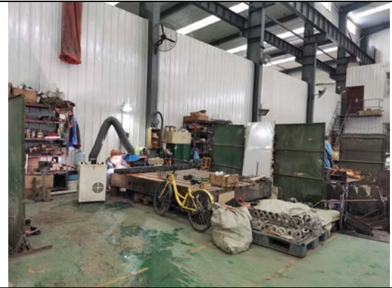
移动式焊接烟尘净化器现状
