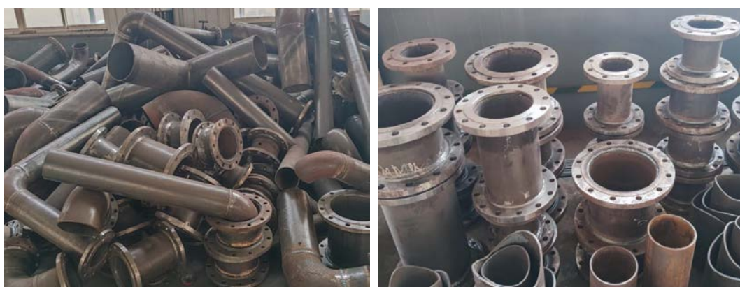
图 2 半成品（法兰短管、弯头管段）堆放
