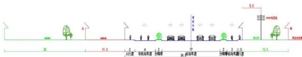
图2-5 昆右线现状断面示意图
