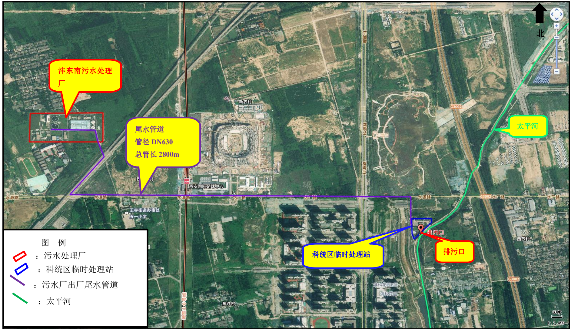
图 2.1-5 沣东南污水处理厂尾水排放去向示意图
