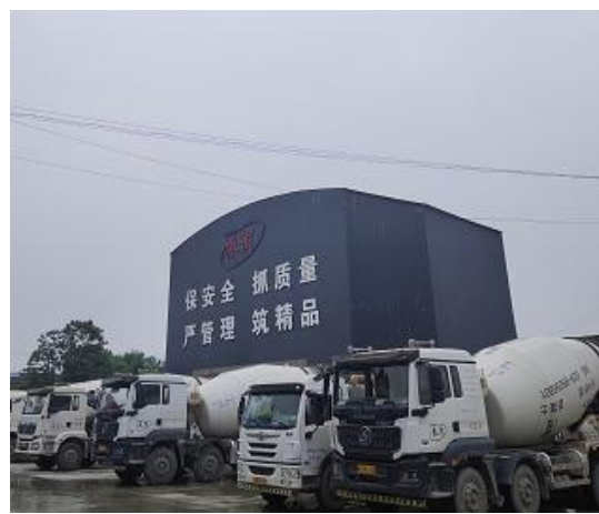
混凝土搅拌站厂房密闭，运输车辆密闭
