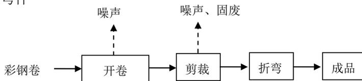
图 2 折弯件生产工艺流程及产污环节图
