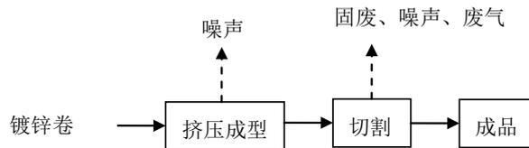
图 4 楼承板生产工艺流程及产污环节图
