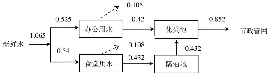
图6 水平衡图 (m³/d)
